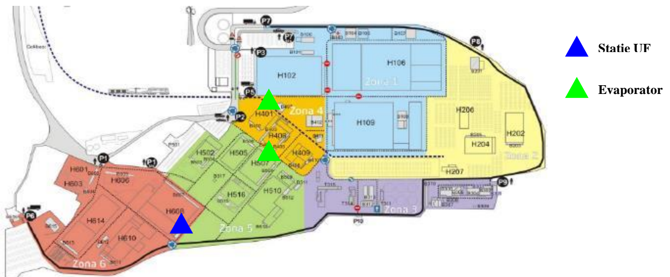
Fig. 5 Amplasare statii de tratare deseuri lichide
